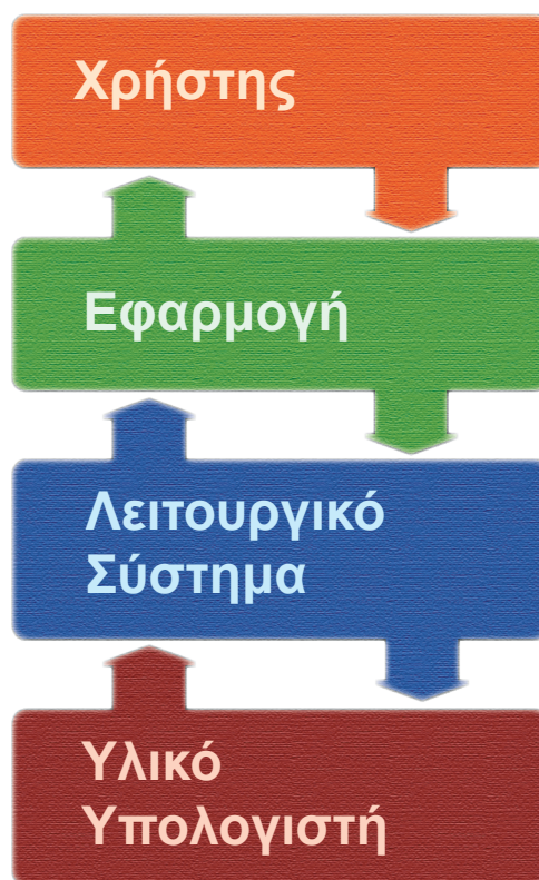
Εικόνα 2.1. Τυπική διαστρωμάτωση λογισμικού. Τα βέλη δείχνουν τη ροή της πληροφορίας.
