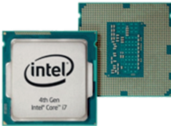
Εικόνα 1.6. Κεντρική Μονάδα Επεξεργασίας
